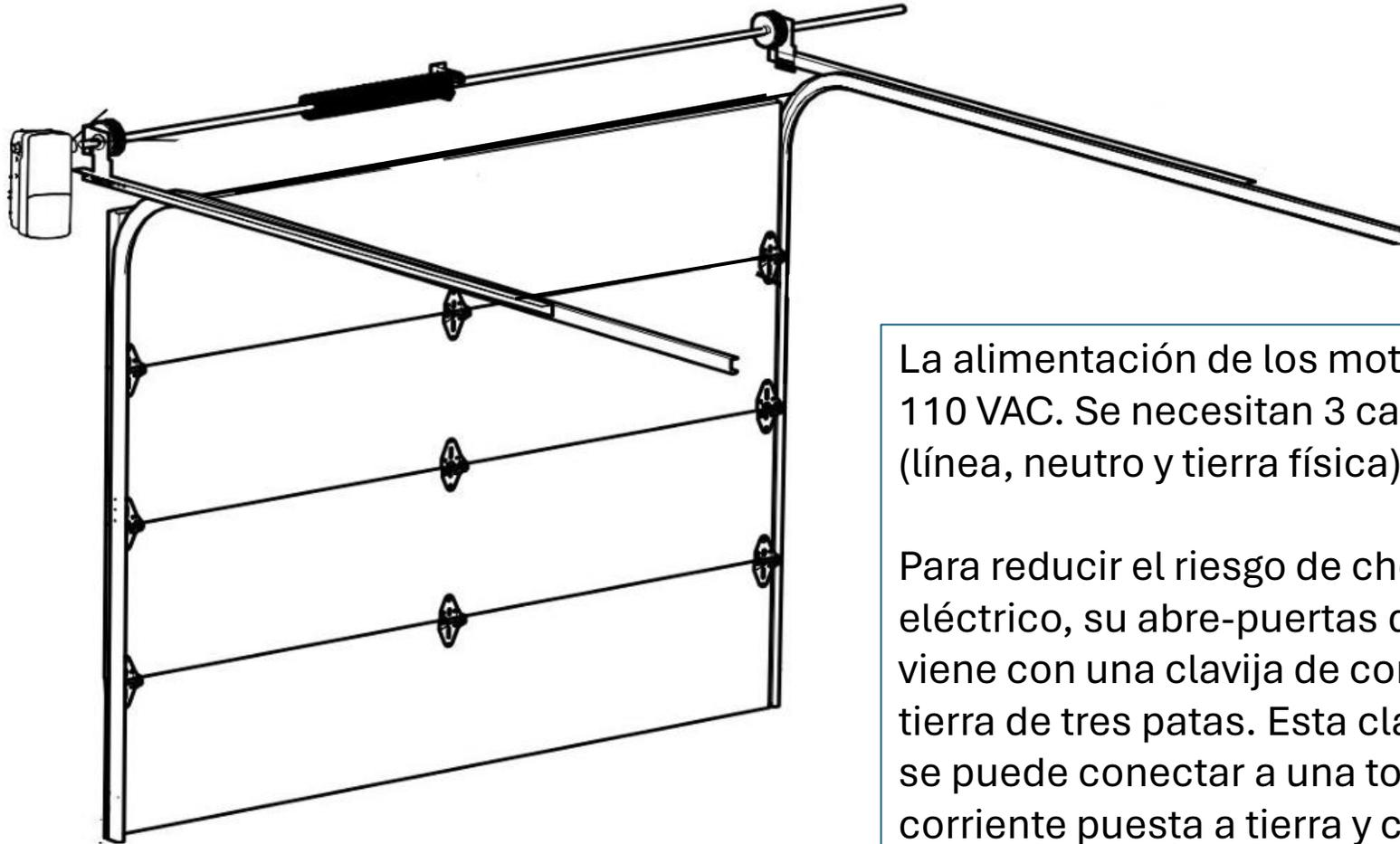
La alimentación de los motores es 110 VAC. Se necesitan 3 cables (línea, neutro y tierra física).
